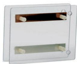
铜银腐蚀试片
