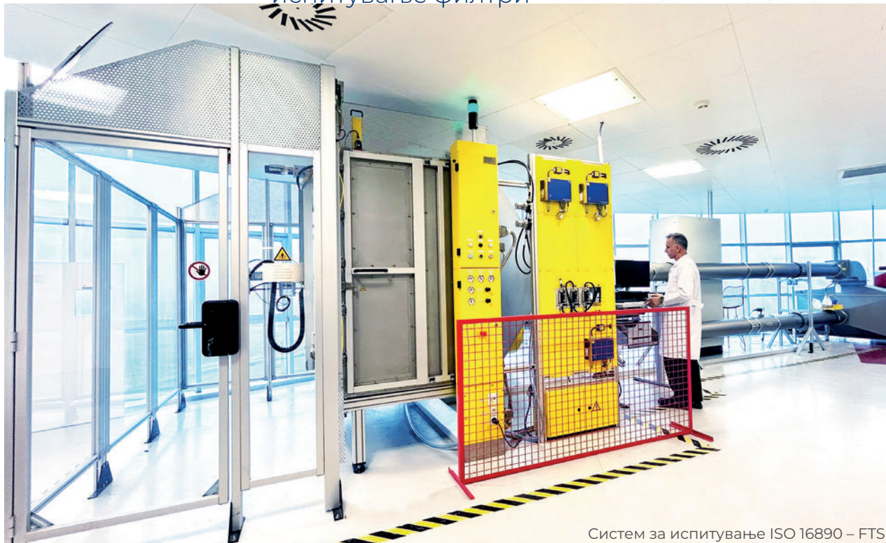
Систем за испитување HEPA / ULPA-филтри – HF-SCAN 4002/2
