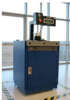
HEPA / ULPA ფილტრების გამოცდის სისტემა HF-OIL MIST FMT 102 1200
