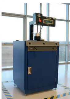
Sustav za ispitivanje filtarskih medija FMT 102
