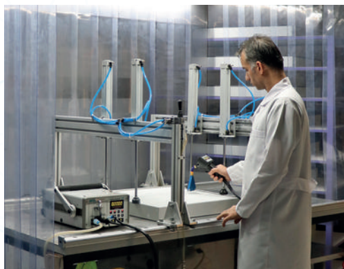
Sustav za ispitivanje HEPA / ULPA filtara – HF-SCAN 3004
