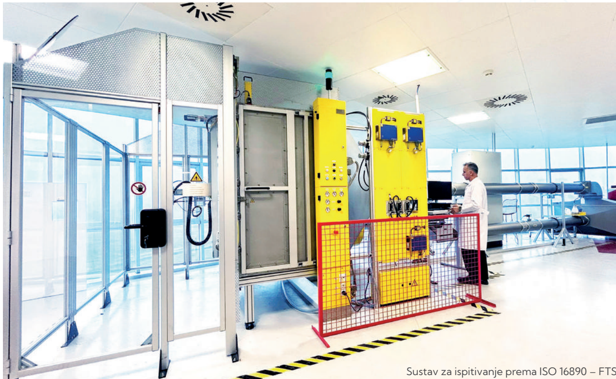
Sustav za ispitivanje HEPA / ULPA filtara – HF-SCAN 4002/2
