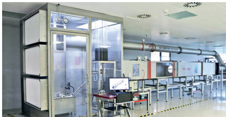
Sustav za ispitivanje prema ISO 16890 – FTS 3401
