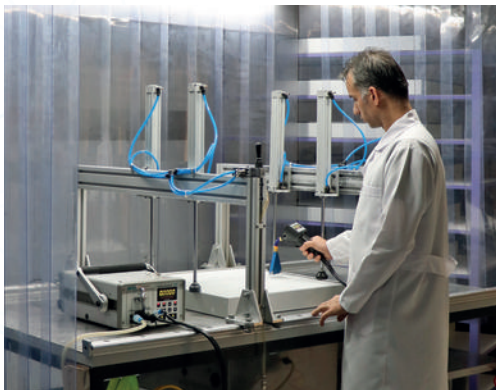
Sistema de ensayo de filtros HEPA / ULPA – HF-SCAN 3004
