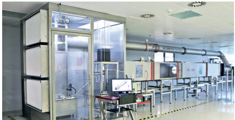
Sistema de ensayo ISO 16890 – FTS 3401
