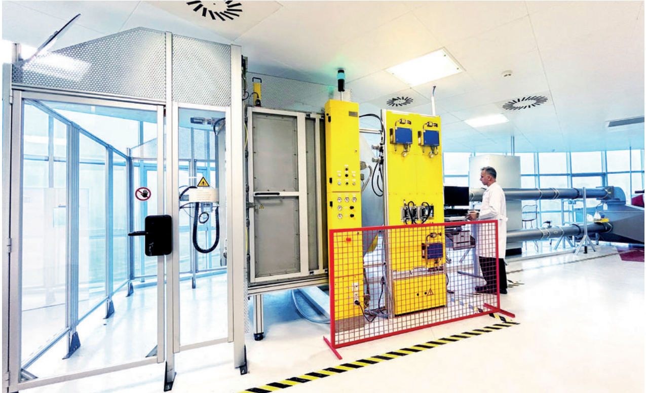
Sistema de ensayo de filtros HEPA / ULPA – HF-SCAN 4002/2
