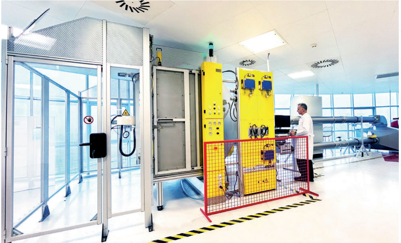
Sistema de prueba de filtros HEPA / ULPA – HF-SCAN 4002/2
