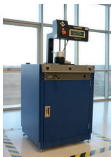
Sistema de prueba de medios filtrantes FMT 102
