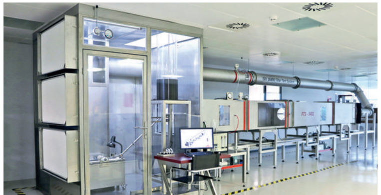
Sistema de prueba ISO 16890 – FTS 3401
