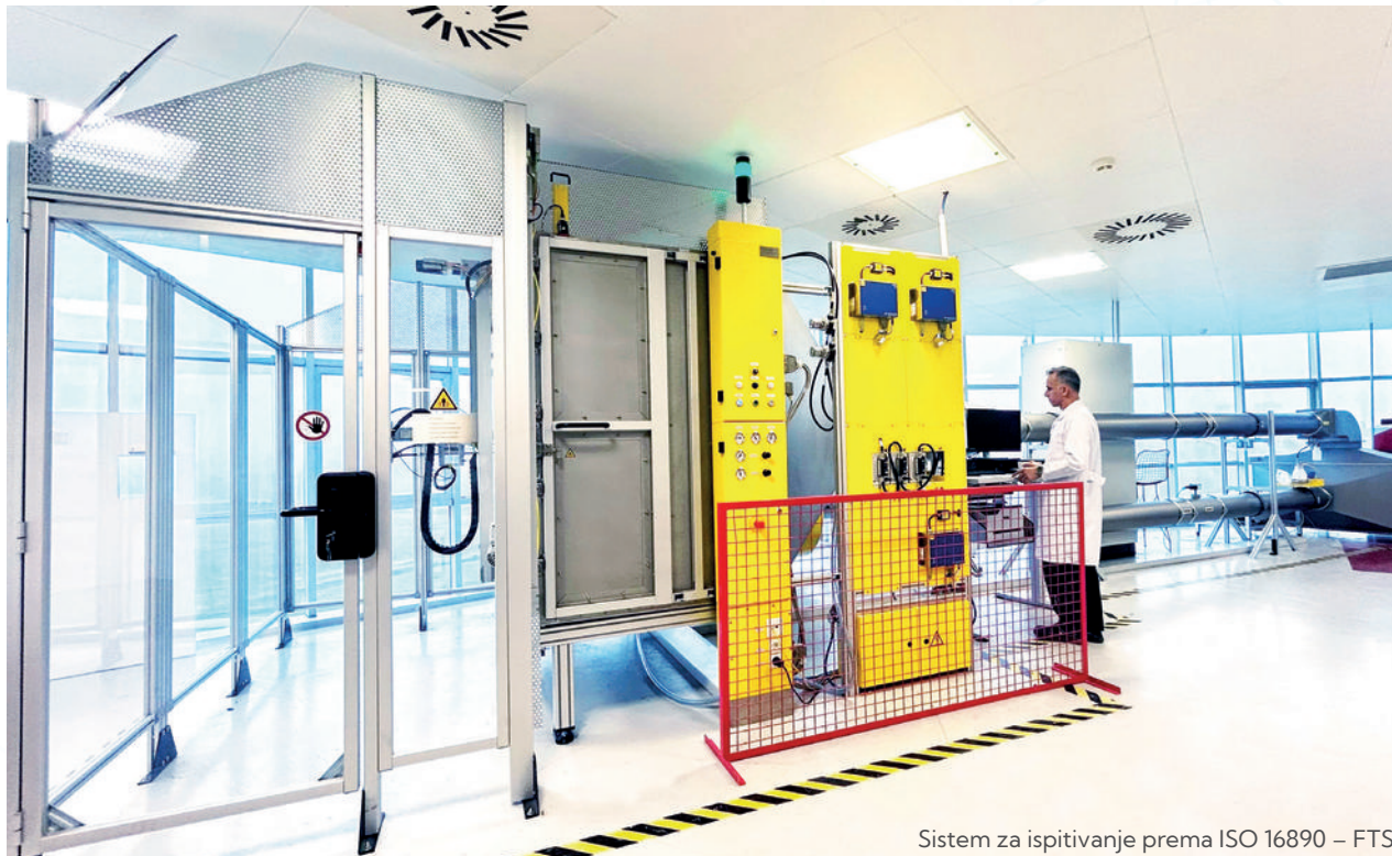
Sistem za ispitivanje HEPA / ULPA filtera – HF-SCAN 4002/2
