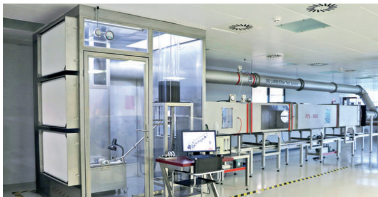
Sistem za ispitivanje prema ISO 16890 – FTS 3401
