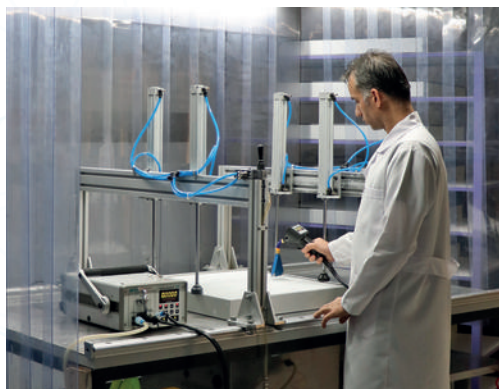
Sistem za ispitivanje HEPA / ULPA filtera – HF-SCAN 3004
