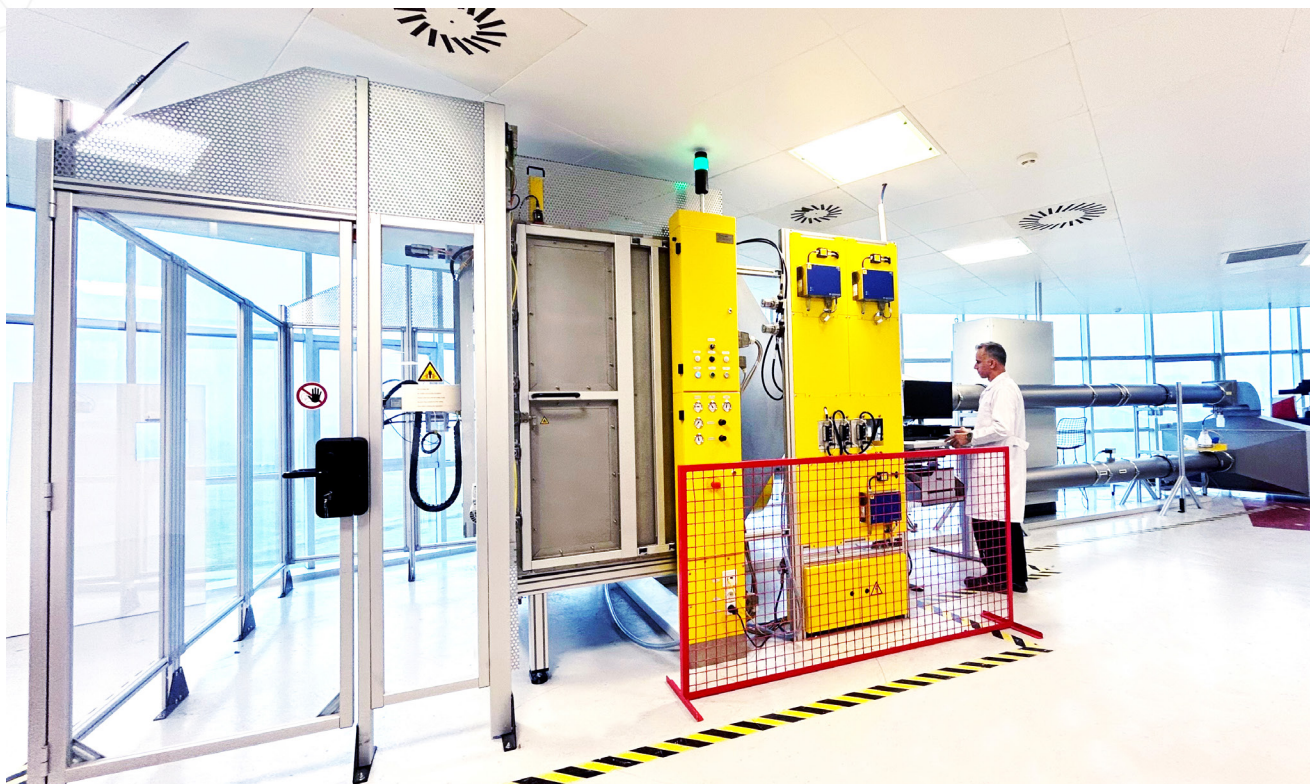
Sistema de ensaio de filtros HEPA/ULPA - HF-SCAN 4002/2
