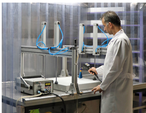
Sistema de ensaio de filtros HEPA/ULPA - HF-SCAN 3004
